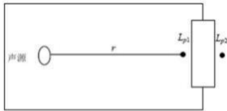
图 A.1 室内声源等效为室外声源图例
